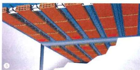
Aver cura di fasciare pilastri, strutture in cemento armato e tubi di scarico onde evitare la trasmissione del rumore attraverso di essi diminuendo la quantità acustica sia verticale che orizzontale.
