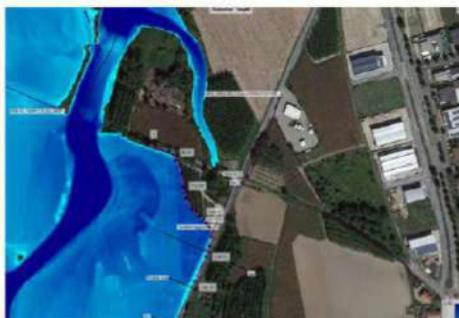
Figura 2\_INT1) modello stato di progetto con aggiunta delle opere specifiche G3A\_CAV - Tr200 anni - pari a 279.45 (scenario 4). La quota di sommità arginale adottata risulta pertanto 280.00 tale quota presenta un franco di 55 cm ed inoltre non sovrasta eccessivamente la quota della SP20.
