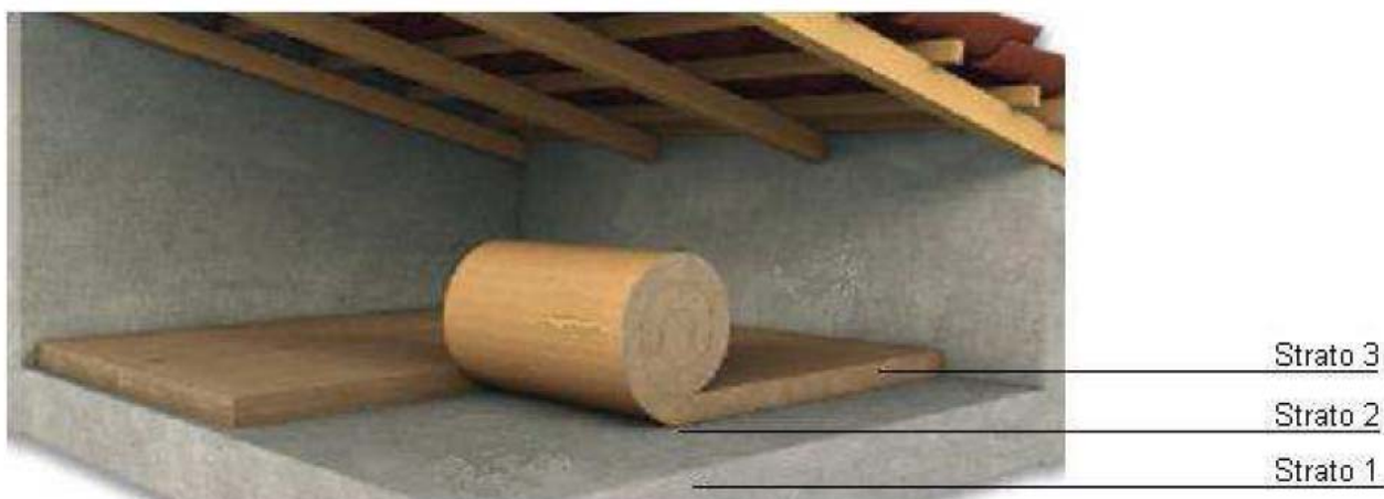
Figura 1: Schema costruttivo dell'intervento
